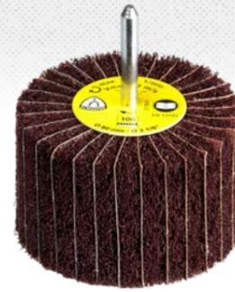
**Vorteile:** Durch Kombination von Vlies- und Schleifgewebelamellen hoher Abtrag bei feinem Schliffbild - Lange Lebensdauer
