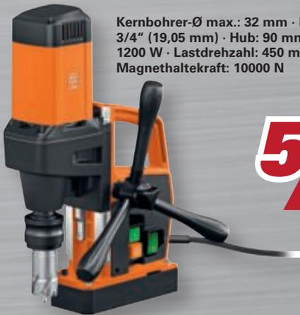
**Kernbohrer-Ø max.:** 32 mm · **Kernbohreraufnahme:** Weldon 3/4" (19,05 mm) · **Hub:** 90 mm · **Nennaufnahmeleistung:** 1200 W · **Lastdrehzahl:** 450 min<sup>-1</sup> · **Magnetfuß:** 175 x 80 mm · **Magnethaltekraft:** 10000 N
